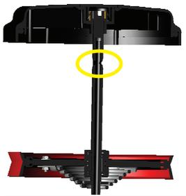
Illustration 11. Coupe transversale de la plaque suiveuse et de la tige de guidage du réservoir de la pompe pneumatique. Les ouvertures de débordement sont mises en évidence.
