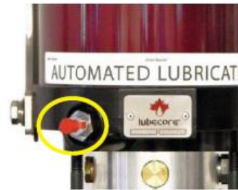
Illustration 37. Raccord de remplissage mâle avec capuchon anti-poussière. Soit une graisse lubrifiante ordinaire pour la graisse EP2, soit un raccord rapide mâle pour la graisse lubrifiante EP0.
