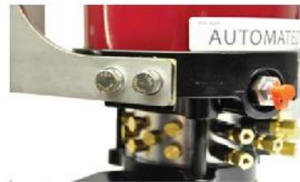
Illustration 20. Pompe avec positions pour 72 éléments maximum.
