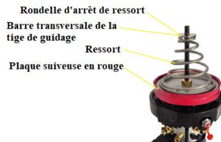
Illustration 25. Plaque Suiveuse et Ressort à PAP
