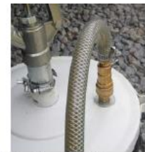
Illustration 36. Faites circuler la graisse lubrifiante pour retirer les poches d'air.
