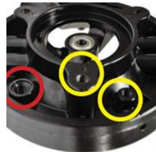
Illustration 16. En jaune, orifices de débordement de la graisse lubrifiante. En rouge, Orifice du capteur de bas niveau
