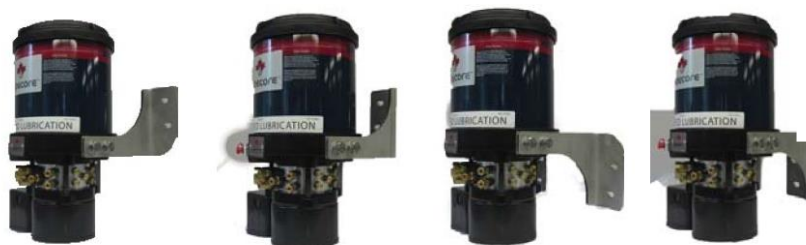
Illustration 20. Options d'installation du support de la pompe : Permutez à gauche/ droite et haut / bas pour obtenir la configuration d'installation souhaitée. [Pompe Spyder]
