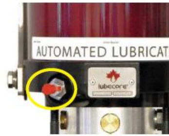
Illustration 37. Raccord de remplissage mâle avec capuchon anti-poussière. Soit une graisse lubrifiante ordinaire pour la graisse EP2, soit un raccord rapide mâle pour la graisse lubrifiante EP0.
