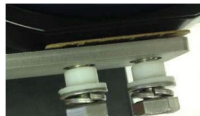
Illustration 19. Ordre d'assemblage du matériel de montage du support de la pompe. (Pré-serrage)
