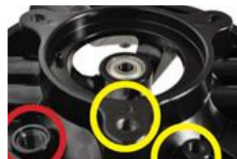
Illustration 17. En Jaune, orifices de débordement de la graisse lubrifiante. En rouge, orifice capteur de bas niveau
