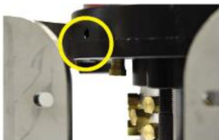
Illustration 15. Emplacement de débordement de graisse lubrifiante
